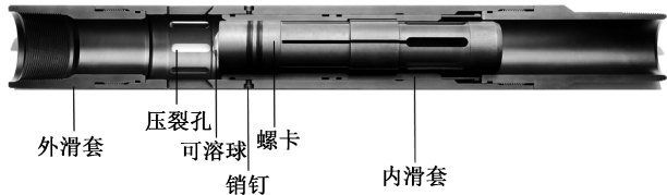
图2 无限级滑套内部结构
